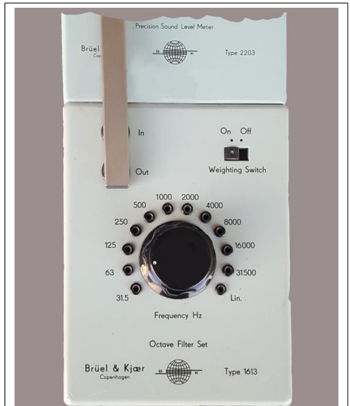
Foto af overfladen på en boks med et 1/3 oktav filter, som kan kobles på en præcisionsstøjmåler fra firmaet Brüel og Kjær.
